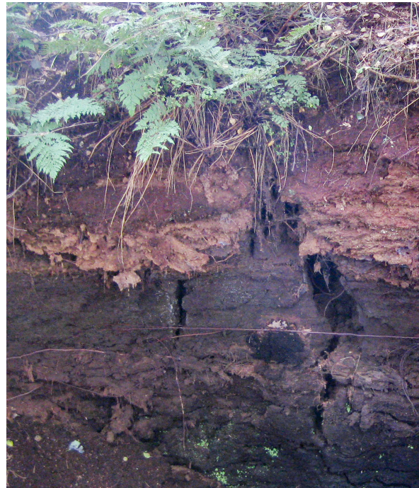
Abb. 5.23.: Abtorfungskante mit Schwarztorf-Weißtorf-Grenze; schrumpfsbedingte Klüfte sind vor allem im Schwarztorfbereich zu erkennen. Foto: ©G.L. Constantin
