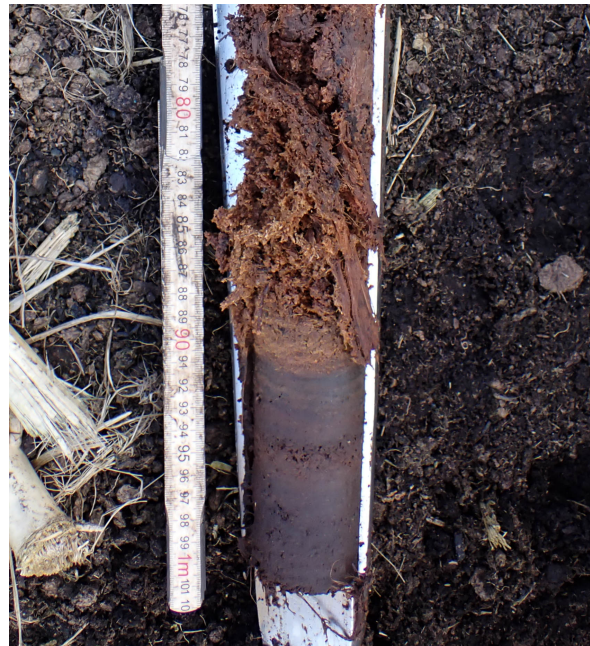
Abb. 5.16.: Scharfe Schwarztorf-Weißtorf-Grenze in der Moorklappsonde an einem Standort in Niedersachsen. Foto: ©G.L. Constantin
