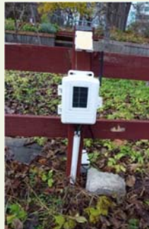
Messung der Bodentemperatur in 4 Tiefen
