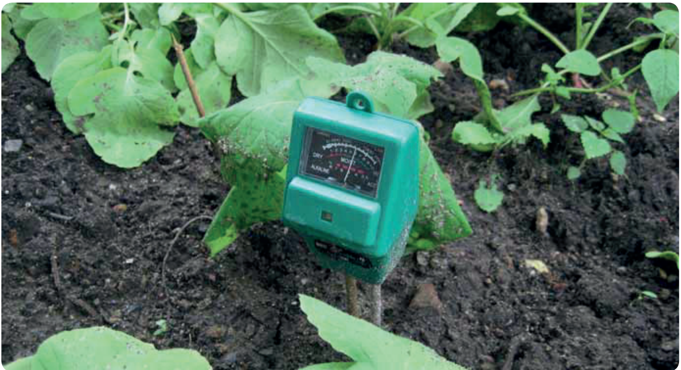
Ein Feuchtemesser (Tensiometer) misst die Saugspannung in Wurzeltiefe und somit die Verfügbarkeit des Bodenwassers für die Pflanzen (Foto: Eva Foos).
